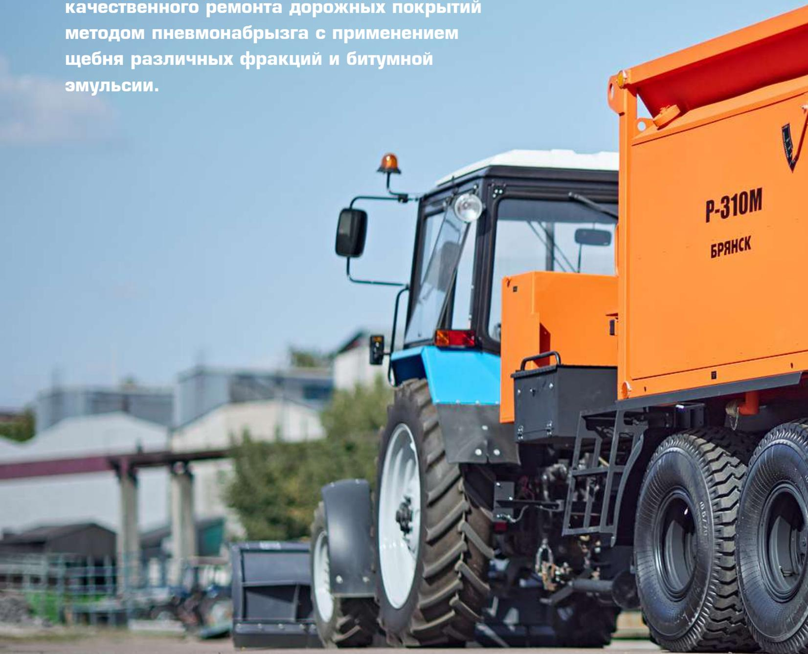
Технологическое оборудование машины смонтировано на двухосном полуприцепе, транспортируемом тракторами.
