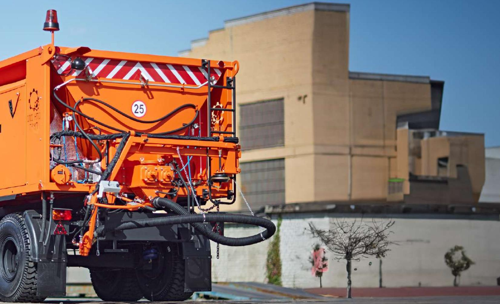
Ямочный ремонт по технологии пневмонабрызга позволяет устранять любые дефекты дорожного полотна без предварительной подготовки асфальтобетонного покрытия.
